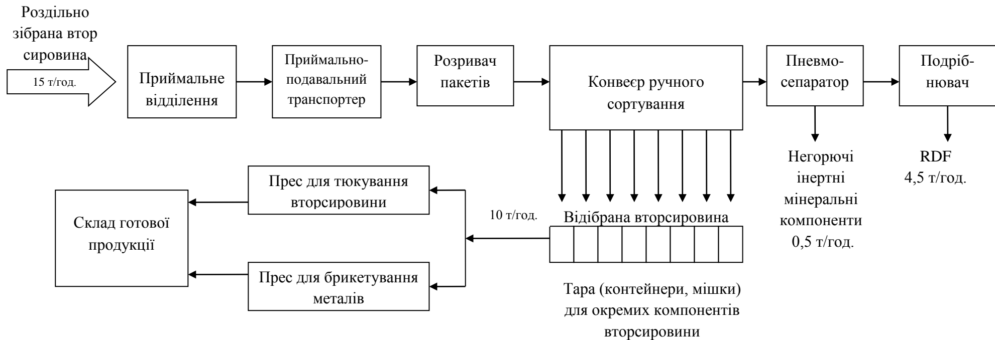
Рисунок 2.3.3.1 Структурно-технологічна схема сортувальної лінії на 60 тис. т на рік. Робота в 2 зміни по 7 год. (300 робочих днів)
